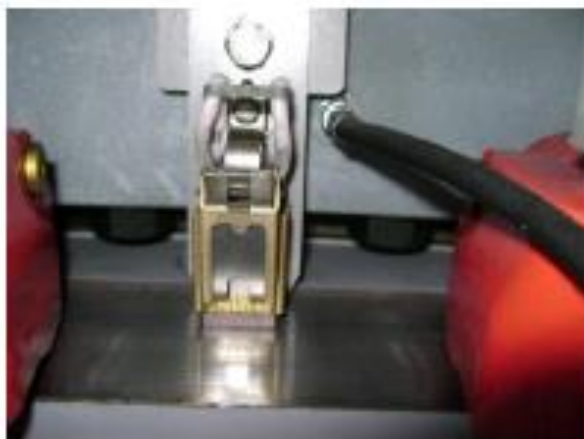
Fig. 6 : Balais de carbone et éclateurs sur le disque de frein d'azimut
